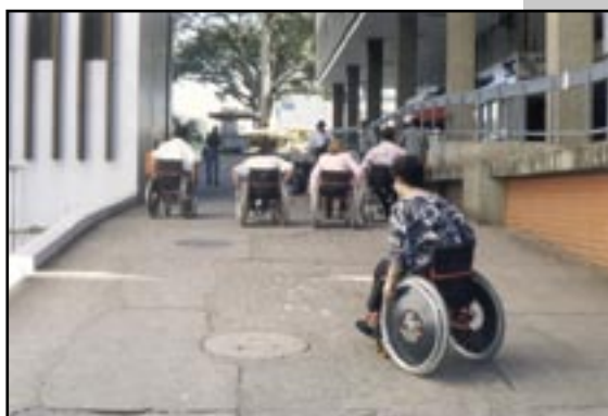
Figura 050 – A imagem flagra uma usuária de cadeira de rodas sem força física para vencer a inclinação exagerada da rampa na mesma dinâmica que os demais do grupo.
