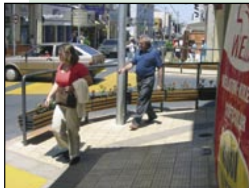
Figura 314 – É prudente a instalação de elementos que direcionem a travessia para os locais mais seguros do cruzamento, em consonância com a faixa de travessia.
