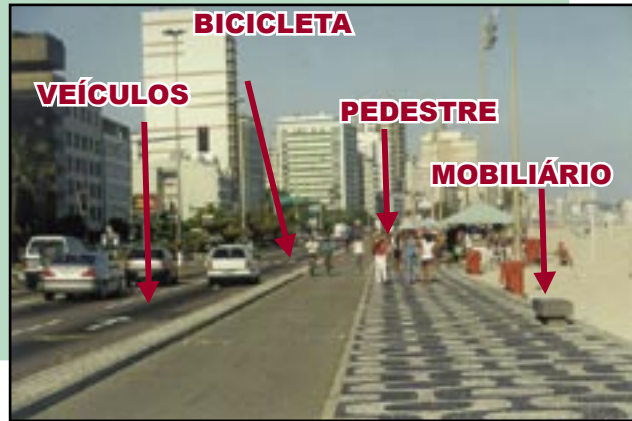
Figura 115 - Via com demarcação da faixa de rolamento para veículos automotores, ciclovia, Calçada com área de pedestre e área destinada à implantação do mobiliário urbano.
