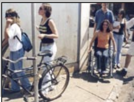
Figura 055 – A largura reduzida da calçada impede a circulação da cadeira de rodas.
