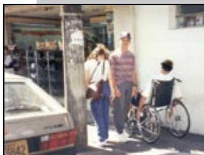
Figura 120 - Passeio público inadequado para a circulação de 2 pessoas em cadeiras de rodas ou 1 pessoa em cadeira de rodas e duas pessoas. A locação do mobiliário pode prejudicar os movimentos.
