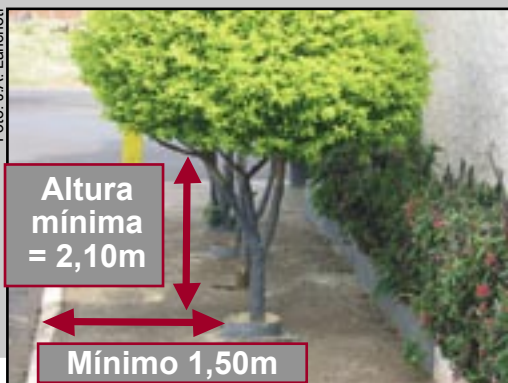
Figura 233 – Situação inadequada de plantio, tanto na escolha da espécie quanto na localização. Não permite a circulação de pessoas na calçada.
