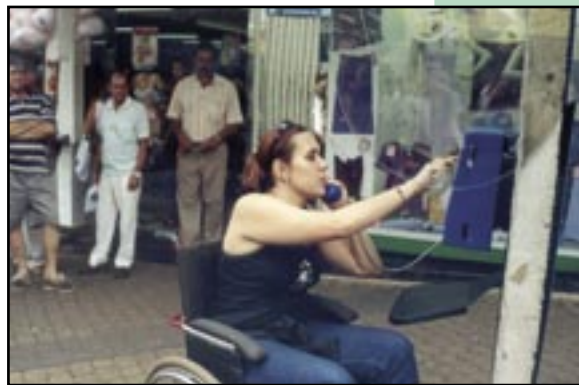
Figura 032 – Aparelho de telefone público instalado em altura tal que atende tanto uma pessoa em cadeira de rodas quanto em pé. Atende o conceito do Desenho Universal.
