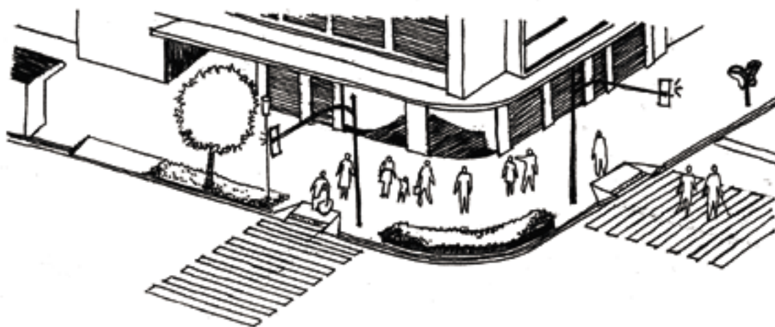
Figura 315 – É importante que as esquinas estejam desobstruídas de qualquer elemento desnecessário para que se permita a aglomeração de pessoas para sua travessia. Deve contar sempre com o rebaixamento do meio-fio em consonância com a faixa de travessia ou outra forma segura e acessível de travessia.
