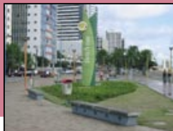
Figura 192 – Vários elementos do mobiliário urbano instalados de forma organizada sem impedir a circulação e permitindo sua utilização. São bancos, lixeiras, luminárias, totem.
