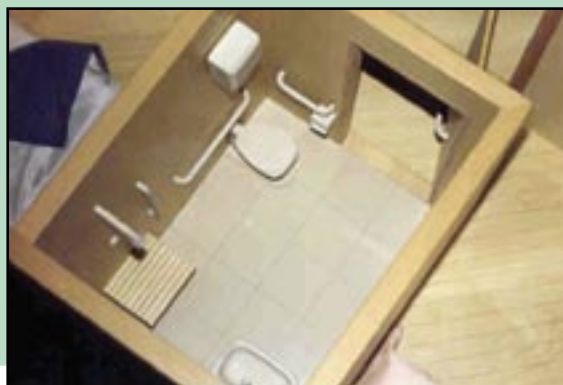
Figura 083 – Detalhe do banheiro acessível, desenvolvido para habitação financiada pela CDHU, sem acréscimo de área total da residência de baixa renda.
