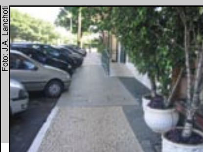
Figura 230 – Vasos com árvores, colocados no passeio público, próximos do alinhamento predial, dificultando a referência de pessoas com deficiência visual que se utilizam alinhamento como guia de deslocamento.
