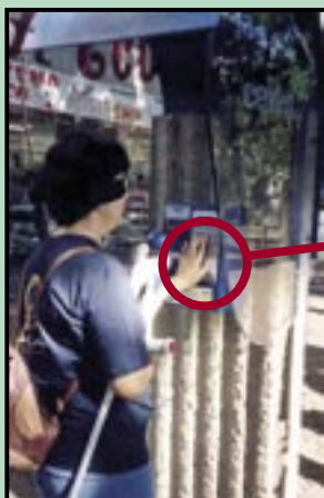
Figuras 042, 043 e 044 – Detalhe de um telefone público que possui uma peça intercambiável (tecla “5”) que possibilita que uma pessoa com deficiência visual identifique o teclado todo.
