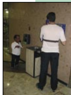
Figura 033 – Telefones Públicos instalados em alturas diferentes buscando atender públicos de diferentes estaturas. Trabalhando-se com o conceito do Desenho Universal é possível com uma única altura atender a todas as pessoas.
