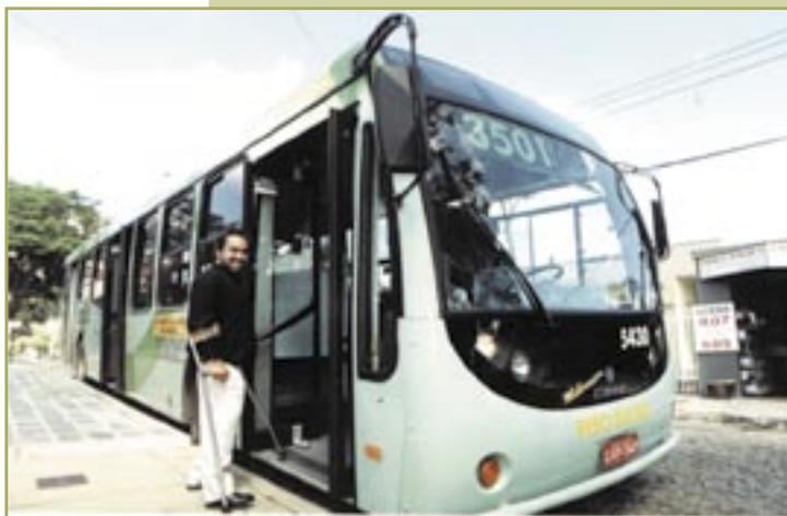
Foto 22 - Microônibus com piso baixo. Embarque ao nível da calçada complementado por rampa basculante do veículo. Campinas, 2006.
