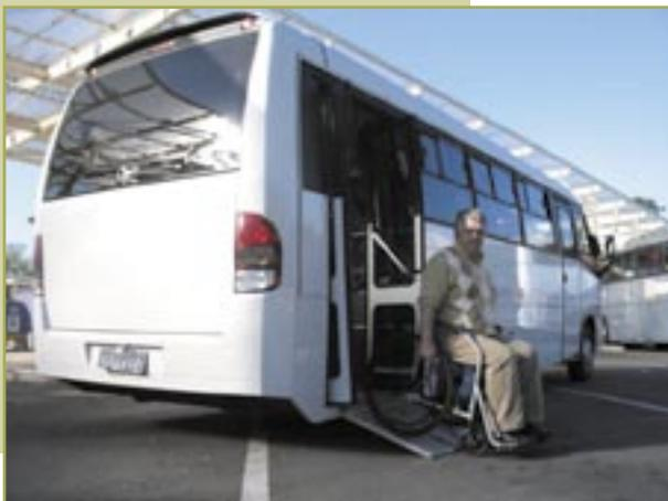
Foto 21 - Ônibus com piso baixo. Embarque ao nível da calçada. Belo Horizonte, 2006
