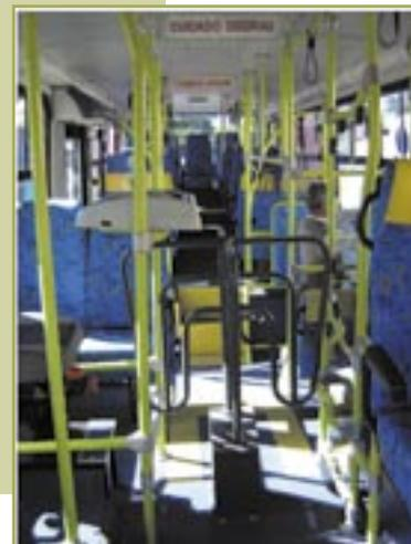
Foto 25 - Interior dos ônibus. Detalhes dos desníveis em amarelo. Campinas, 2006
