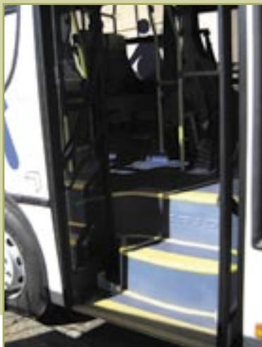
Foto 23 - Interior dos ônibus. Detalhes como balaústres, corrimãos e pegamãos em amarelo. Campinas, 2006.
